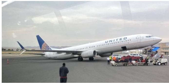
სურ. 1. საჰაერო ხომალდიდან მგზავრების გადმოსმის და ბარგის არასწორი გადმოტვირთვის შედეგად მიღებული წონითი დისბალანსი
