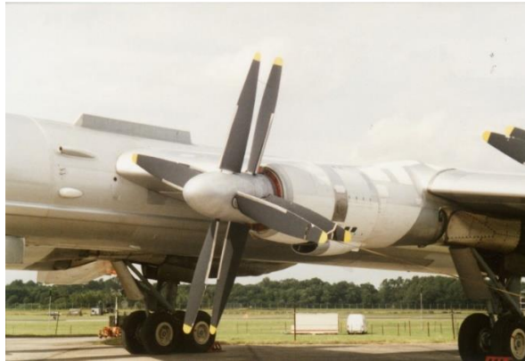
სურ.1 თვითმფრინავი TU-95 თანალერძული ხრახნის სისტემით
